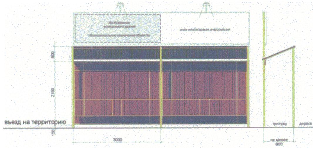
Информационный щит строительного объекта располагается над строительным ограждением.
