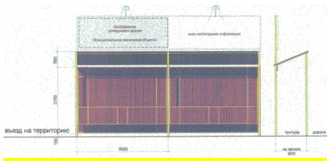
Информационный щит строительного объекта располагается над строительным ограждением.
